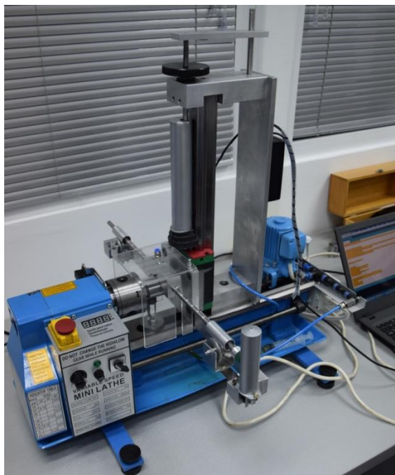
Слика 14 – Специјално дизајниран уређај за испитивање резања константном силом
